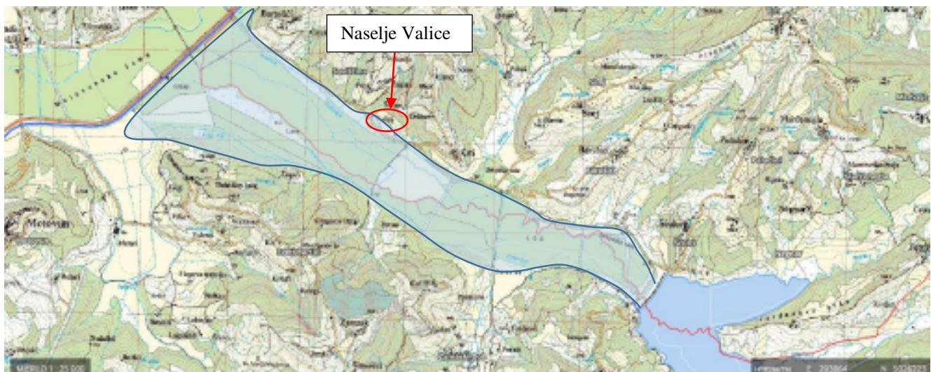
Slika 9: Područje maksimalnog plavljenja nizvodno od akumulacije Butoniga
